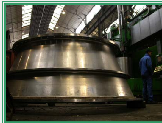
CHAMBRE D'IMPULSEUR POUR HYDROJET Acier duplex GX2CrNiMo 22-5-3 Poids net : 4 700 kg
