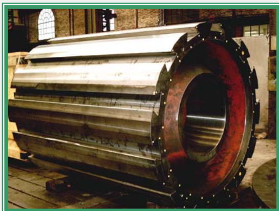
MOYEU DE MOTEUR DE PROPULSION MARINE EN GJS-450-10 Poids net : 17 850 kg
