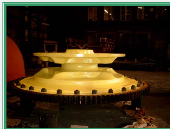
BARBOTIN DE CABESTAN GS 12MnNiMo 5.5 Poids net : 7 200 kg
